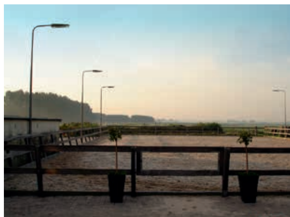
De gemeente stelt eisen aan de verlichting van de rijbak. LED lampen in groene kleur (voor vogels en geel voor vleermuizen) hebben het minst storende effect.
